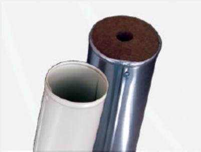
Цилиндры с покрытием **METAL** (представляют собой теплоизоляционную конструкцию с кровным слоем из оцинкованной стали толщиной 0,55 мм, кожух служит для защиты от значительных механических воздействий. Возможно изготовление кровного слоя из алюминия или нержавеющей стали).
