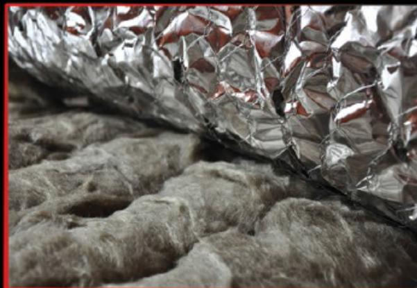
С одной стороны мат покрывается алюминиевой фольгой толщиной 35-50 мкм и сеткой из гальванизированной стальной проволоки диаметром 0,5 (возможна облицовка нержавеющей сеткой). Маты прошиваются нержавеющей проволокой.
