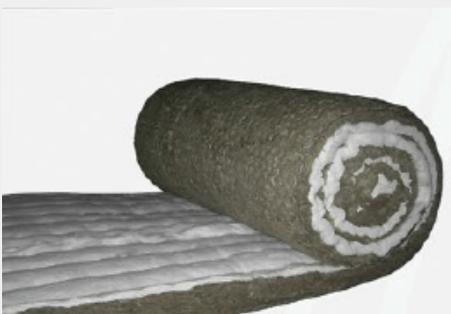
Маты combi изготавливаются в виде многослойной конструкции, где прилегающая к поверхности изолируемого объекта сторона изготовлена из мулито-кремнеземистого волокна, выдерживающего температуру до 1100°C. Применение такой продукции рекомендовано на трубопроводах с рабочей температурой теплоносителя более 600°C.
