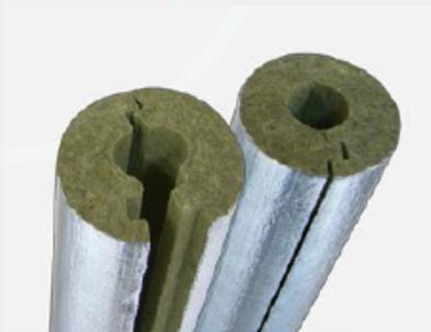
Цилиндры капированные армированной алюминиевой фольгой (алюминиевая фольга в данном случае выполняет функцию пароизоляции и эстетическую функцию в случае, когда изолируемый объект находится в помещении и нет необходимости в дополнительной защите от механических воздействий и воздействий окружающей среды).
