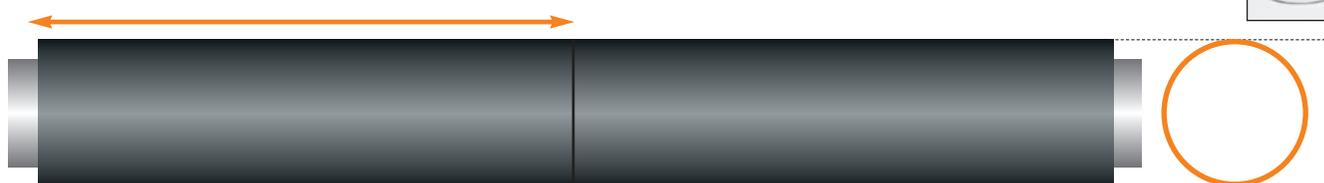
**B)** После обработки подлежащих склеиванию поверхностей наждачной бумагой (нахлест и поверхность, на которую наклеивается нахлест), установите лист на трубу, не допуская попадания влаги на места соединения продольного шва.
