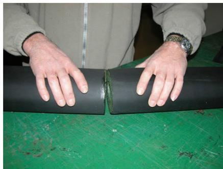
Соедините две трубки и склейте шов.
