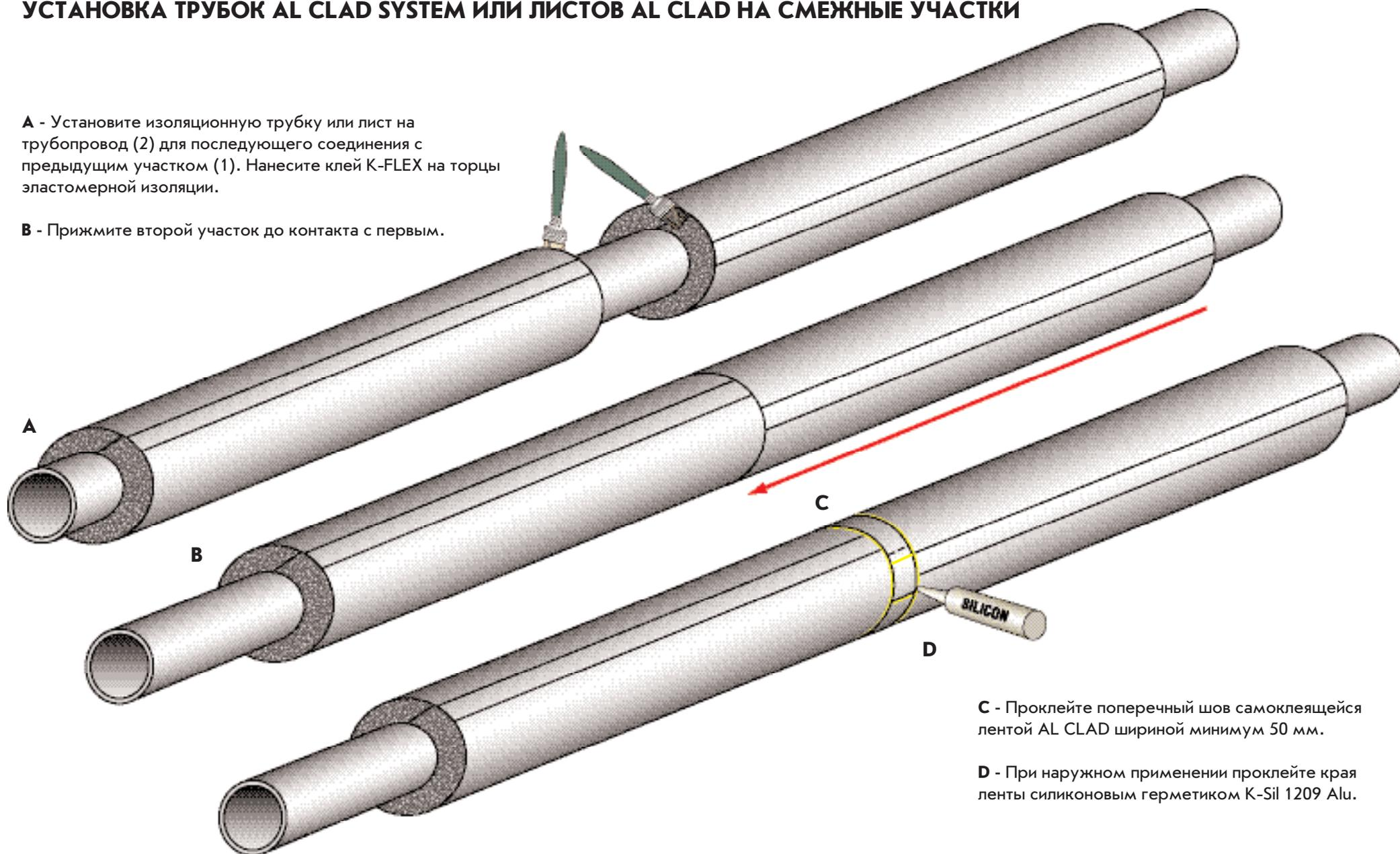
**C** - Проклейте поперечный шов самоклеящейся лентой AL CLAD шириной минимум 50 мм.
