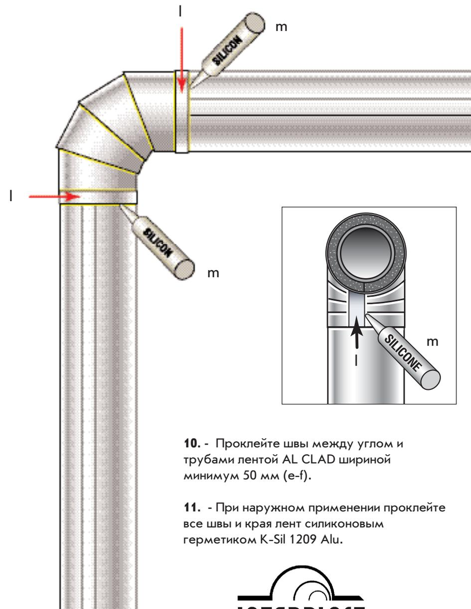
10. - Проклейте швы между углом и трубами лентой AL CLAD шириной минимум 50 мм (e-f).
