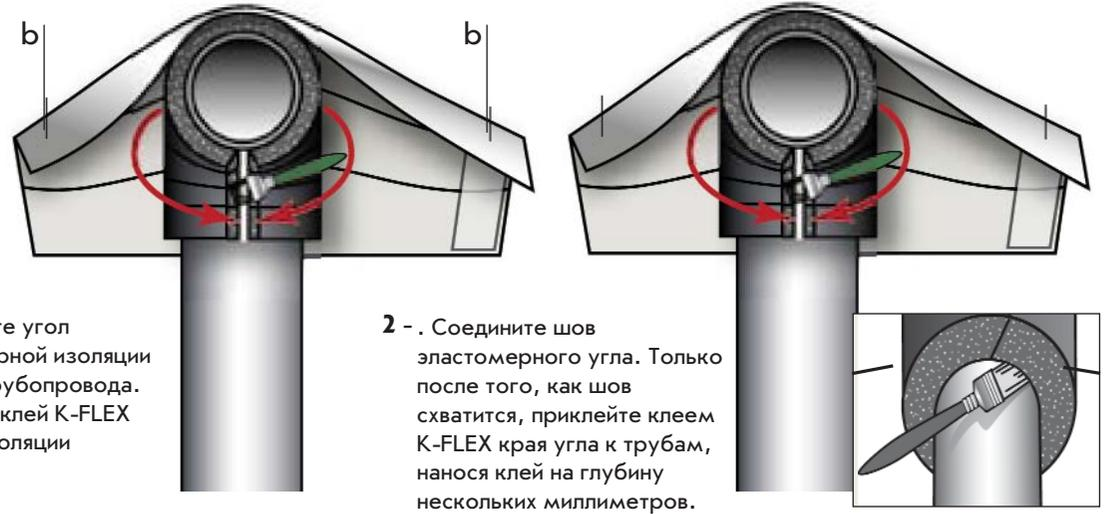
1 - Установите угол эластомерной изоляции на угол трубопровода. Нанесите клей K-FLEX на шов изоляции
