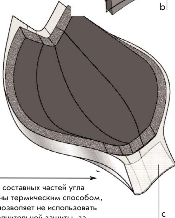
Швы составных частей угла спаяны термическим способом, что позволяет не использовать дополнительную защиты, за исключением наружного применения.
